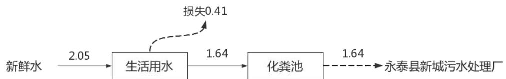
图 2.4.1 本项目水平衡图（单位：t/d）
