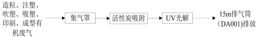
图 4.2.1 本项目废气处理工艺
