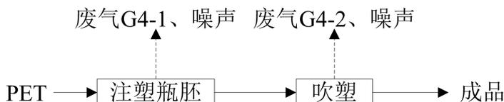
图 2.6.4 PET 瓶生产工艺及产污环节图
