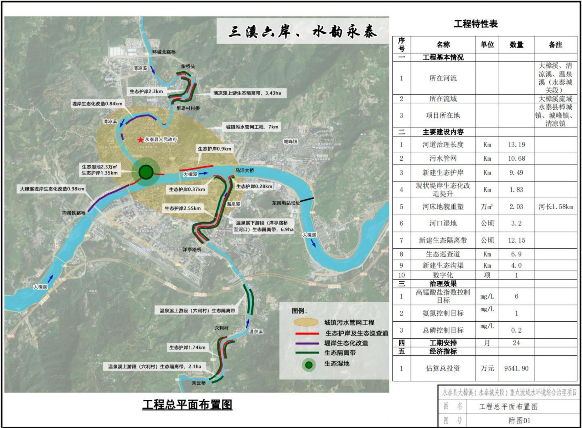
附图3 工程总平面布置图
