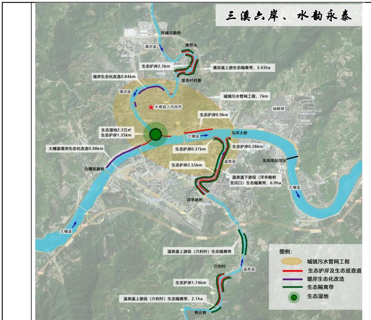
图 2-1 项目总平面布置图
