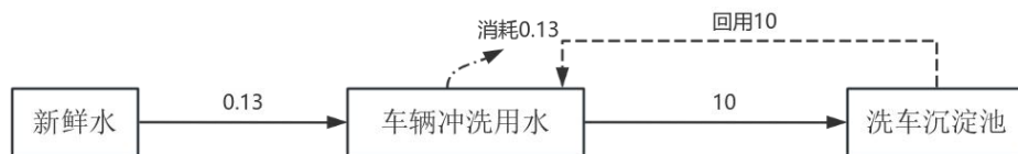
图 2.2-2 项目二期水平衡示意图 (t/d)
